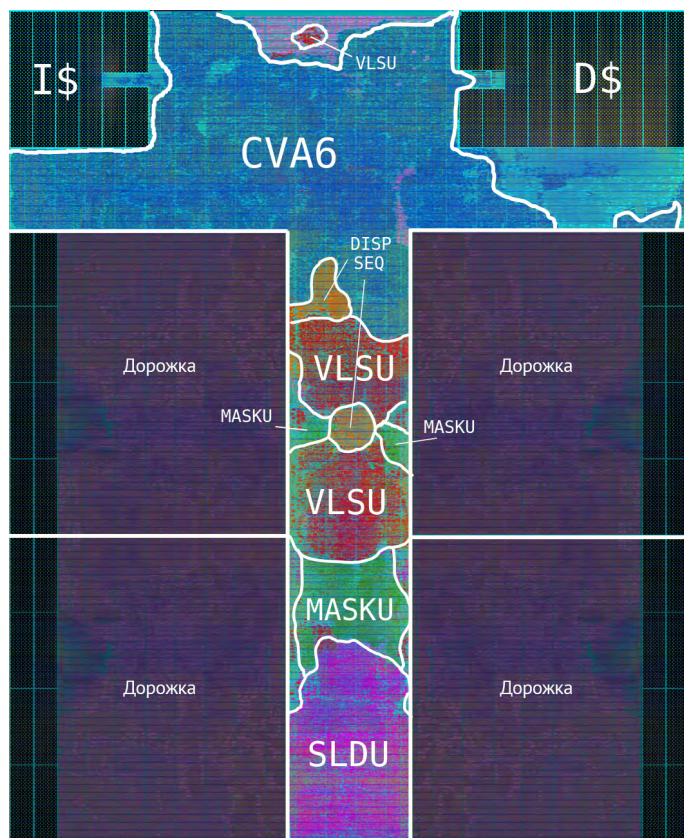
Рисунок 4. Физическая реализация полной системы. Дорожка реализуется и заключается в макрос, а затем помещается на матрицу. Вход и выход системы находятся в верхней части кристалла (интерфейс AXI).
